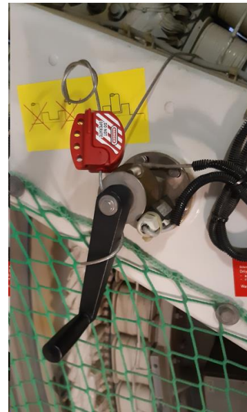
Con el bulón ya insertado, manivela fijada mediante trabado de sirga. With the bolt already inserted, crank handle fixed by cable device.
